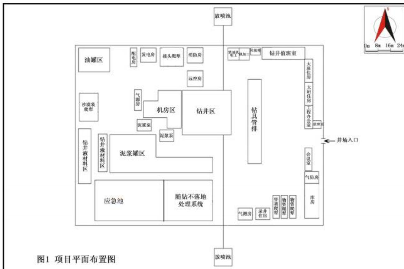
图 2-3 钻井井场平面布置示意图
